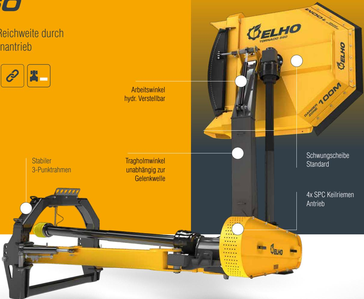
**Der Tornado 560 ist ein mechanisch antriebener Kettenmulcher** mit beeindruckender Arbeitsreichweite von 5,5 Metern. Der zusätzliche Keilriemenantrieb ermöglicht, Dank Winkelgetriebe, ein Arbeiten bei jedem Winkel des Muckkopfes.
