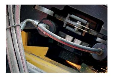
Das Schleifen der Messer erfolgt super einfach per Knopfdruck am ISO Bus Terminal. Ebenso die Justierung der Gegenschneide.
