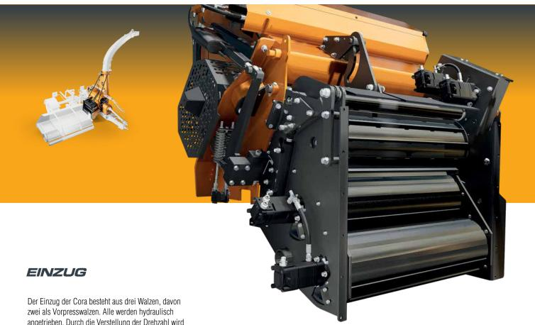
Der Einzug der Cora besteht aus drei Walzen, davon zwei als Vorpresswalzen. Alle werden hydraulisch angetrieben. Durch die Verstellung der Drehzahl wird die Schnittlänge des Futters verändert, stufenlos von 4-18mm. Die Einstellungen werden über das ISO Bus Terminal getätigt. Ebenso der Vorpressdruck.
